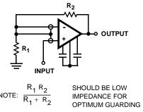
FIGURE 1C. NON-INVERTING AMPLIFIER
