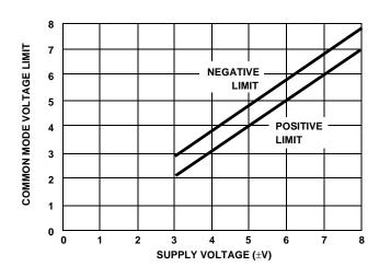
FIGURE 10. COMMON MODE INPUT VOLTAGE RANGE vs SUPPLY VOLTAGE
